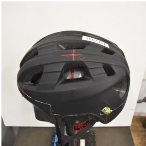
Site C - Hazard (V) anvil
